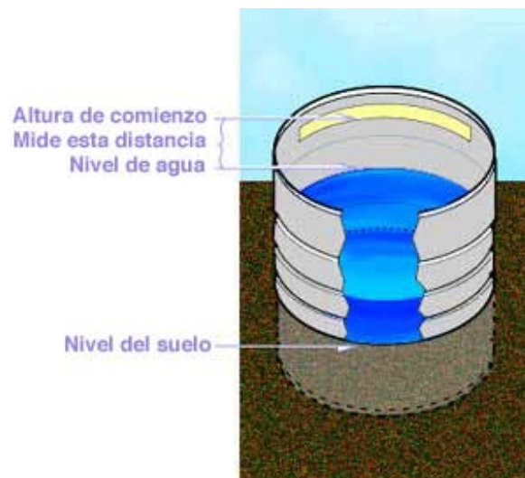
Anexo 7. Ensayo de permeabilidad Fuente: www.seed.slb.com/es/lab/permeability
